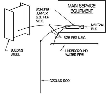
ELECTRICAL SYSTEM GROUNDING & BONDING
