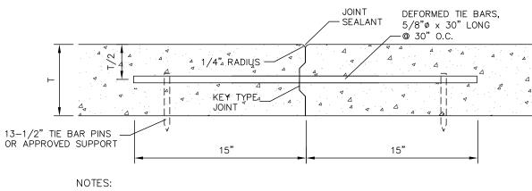
1. KEY TYPE JOINT SHALL BE USED ON ALL LONGITUDINAL CONSTRUCTION JOINTS WHEN ADJACENT LANE IS NOT POURED AT THE SAME TIME ALTERNATIVE METHODS FOR KEY TYPE JOINT SHALL BE PRESENTED TO
